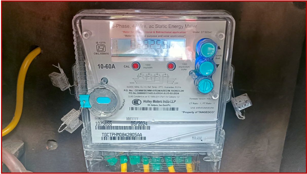
Fig. 3.3 Smart Energy Meter
